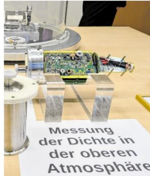
Elektronik und Sensoren für die Messungen der oberen Atmosphäre.
