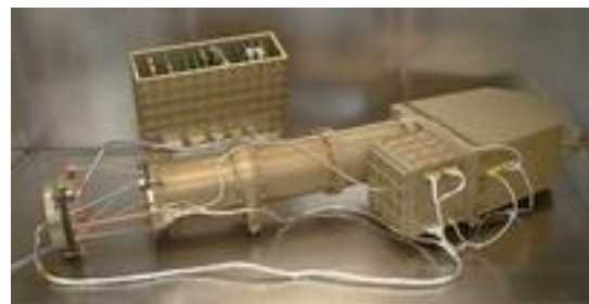
Abbildung 2: Das CIDA-Instrument, bestehend aus Sensor (im Vordergrund) und Elektronik-Box (geöffnet, im Hintergrund). Foto: vH&S
